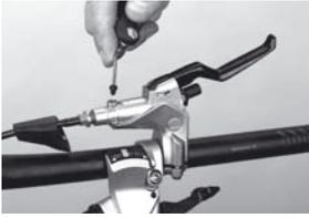
7. EBT (Easy Bleed Technology steht für "leichte Befülltechnik") Stopfen mittels Inbus Schlüssel SW 2,5 aushebeln.
