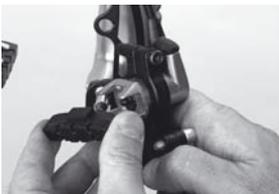
7. Vor Montage der rechten Seite Bremsbelagswechsel üben. Es ist kinderleicht: Ausklippen, einklipsen - fertig. Schnellspannerseite aufstecken und Schnellspanner schließen.
