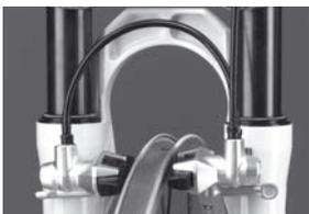
**2. Schließen:** Bremszylinder zurück in Fahrposition schwenken und Schnellspanner in Richtung Gabel drücken. So einfach ist das bei FIRM-tech! **Ein Booster ist bei FIRM-tech nicht notwendig, und es kann auch keiner montiert werden!**
