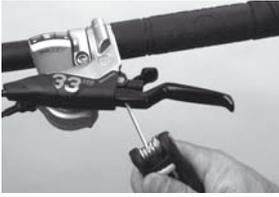
**14. Die Griffweiteneinstellung** erfolgt mittels Inbusschlüssel SW 2,5. Eindrehen im Uhrzeigersinn: Hebel wandert zum Lenker hin. Herausdrehen: Hebel wandert vom Lenker weg.
