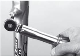
3. Schnellspannerschraube in den in Fahrtrichtung linken (VR) bzw. rechten (HR) Cantisockel mit Inbusschlüssel SW5 **LEICHT** einschrauben. **Beachten Sie den Punkt 12. auf der folgenden Seite!**
