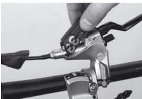
11. Abdeckkappe wie gezeigt auffädeln und auf den Bremsgriff clipsen. Leitungstülle an Bremsgriff schieben. Bremsgriff in Fahrposition drehen und mit korrektem Drehmoment verschrauben (Siehe Seite 7 Punkt 2)
