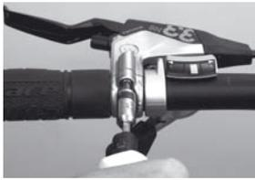
1. Bremsgriff mit Inbusschlüssel SW4 am Lenker montieren
