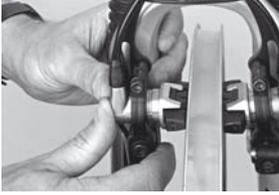
9. Bremszylinder auf Anschlag Richtung Felgenflanke drücken. Die Beläge sind **PARALLEL** zur Felgenflanke zu positionieren.
