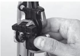
6. Obere Führungszapfen des Adapters in die Bohrung der Montageplatte einführen. Einheit links mit Inbus SW 5 montieren. **Befestigungsschrauben nur leicht anziehen.**
