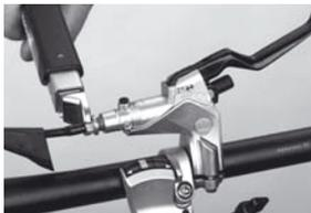
6 Bremsgriff wie gezeigt nach oben drehen, fixieren, und Leitungsanschluss mittels Gabelschlüssel SW 8 LEICHT lösen, bis 3 Gewindegänge der Anschluss-Schraube sichtbar sind.
