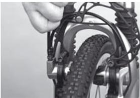
9. **Wichtig: Nach Kürzen der Bremsleitung immer durch Ziehen an der Bremsleitung auf korrekte Verbindung prüfen. Bremse immer auf Dichtigkeit prüfen, d.h. Bremshebel betätigen, halten und Anschlüsse auf Leckagen untersuchen.**
