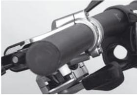
2. Die Seite der Befestigungsschelle mit den angedeuteten Pfeilen zeigt nach oben und wird auf Block verschraubt. Tipp: Wenn der Bremsgriff sich mit Kraftaufwendung noch auf dem Lenker verdrehen lässt, erspart dies die Folgen von teuren Sturzschäden.
