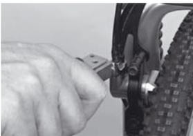
8. Überwurfschraube erst mit Hand, dann mit Gabelschlüssel (SW 8) anziehen.
