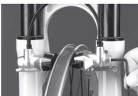
**4. Bei FIRM-tech erfolgt die Einstellung auf unterschiedliche Felgenbreiten beiderseits mittels Inbus SW 5.**
