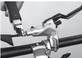
10. Leitungsanschluss wieder verschrauben (Max. Anzugsdrehmoment 4Nm). Befüllspritze am Bremszylinder entfernen, Befüllschraube festdrehen (Anzugsdrehmoment 4Nm).
