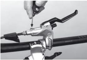
9. EBT Stopfen mittels Inbusschlüssel SW 2 oder, noch einfacher mit dem Daumen wieder aufdrücken.
