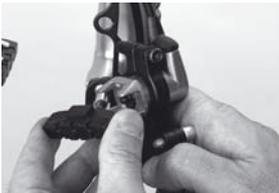
3. Zum Belagswechsel den Schnellspanner öffnen. Alten Belag ausklipsen, neuen Belag einklipsen. Auf der gegenüberliegenden Seite entweder bei geöffnetem Schnellspanner das Laufrad kippen/ausbauen oder Adapter durch Lösen der zentralen Befestigungsschrauben (Inbus SW 5) abnehmen. Belag wechseln, Adapter wieder befestigen, fertig.
