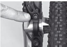
13. EVO 2 Booster-Montage: Montieren Sie den Booster gemäss dem beiliegenden Montagezettel. Die Seite mit dem Langloch wird auf der Schnellspannerseite montiert (Inbus SW 5). Unterlegscheibe unter Schraubenkopf nicht vergessen, **max. Anzugsdrehmoment 6 Nm**. Gegenüberliegende Seite (siehe Finger) wird nur aufgesteckt.
