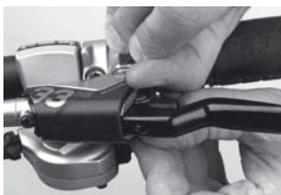
5. Abdeckkappe wie gezeigt seitlich beidseitig anheben und Richtung Leitungsanschluss aushebeln.
