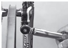
12. Die Vorspannung des Schnellspanners wird durch Ein- und Ausschrauben der Schnellspannerschraube bei geschlossenem Schnellspanner eingestellt!
