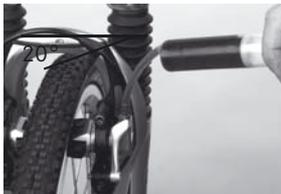
3. Befüllschraube (Inbus SW 5) am Bremszylinder öffnen, Spritze in Bremszylinder schrauben und **mit Gabelschlüssel SW 8 festziehen**
