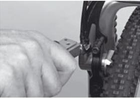
4. Hauptleitung am Bremszylinder öffnen. Werksseitig montierten Stutzen M8 lösen (Gabelschlüssel SW 8).
