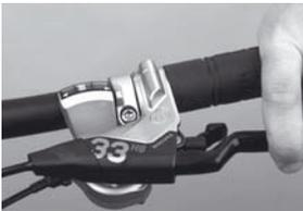
10. Bremshebel **LEICHT** betätigen, um die Bremszylinder von der Felge wegzudrücken. Schrauben festziehen, sobald zwischen Belag und Felgenflanke ein Abstand von 2mm erreicht ist. Beachten Sie die in Punkt 11 genannten Drehmomente.
