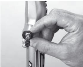
4. Je eine Unterlegscheibe mit abgeflachter Seite nach oben auf die Cantisockel schieben. Die Montage dieser Unterlegscheiben ist kein Muss, kann jedoch dann notwendig sein, wenn der obere Teil der Montageplatte z.B. an den Versteifungsbügel einer Federgabel anstößt. **ACHTUNG: Maximal EINE Unterlegscheibe pro Seite unterlegen!**
